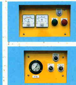
5. 操作盤(操作部)
